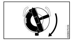
En maintenant la pression sur le bouchon du réservoir, le tourner dans le sens des aiguilles d'une montre jusqu'à ce qu'il s'encliquette.
