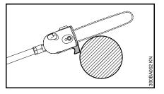
Pour exécuter la coupe de séparation, appliquer le guide-chaîne de telle sorte que le crochet se trouve tout près de la branche. Cela évite que la machine soit soumise à des mouvements brusques au commencement de la coupe de séparation.
