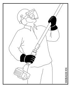
Pour pouvoir manier la machine en toute sécurité, toujours la tenir fermement à deux mains – la poignée de commande de la main droite, le tube de la main gauche – ceci est également valable pour les gauchers. Entourer fermement la poignée de commande et le tube avec les pouces.
