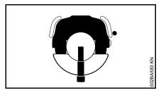
Le bouchon du réservoir est verrouillé.
