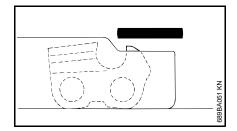
rectifier le limiteur de profondeur de telle sorte qu'il affleure avec le calibre d'affûtage;
