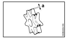
après avoir usé deux chaînes ou plus tôt, si la profondeur des traces d'usure (a) dépasse 0,02 po (0,5 mm) – sinon la durée de vie de la chaîne serait réduite – pour le contrôle, utiliser le calibre de contrôle (accessoire optionnel).
