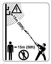
À part l'utilisateur, personne ne doit se trouver dans un rayon de 15 m de la machine en marche – **risque de blessure** par les branches qui tombent et les particules de bois projetées!
