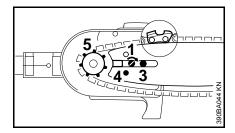
glisser le guide-chaîne par-dessus la vis (3) et placer le trou de calage (4) sur le téton du coulisseau
