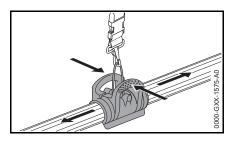
Ouvrir la pince d'attache en pressant les languettes et fixer la pince d'attache sur le tube.
