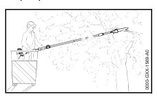
Grâce à la grande portée du tube, il est possible de couper des branches tout près du tronc sans endommager d'autres branches avec la nacelle élévatrice. L'angle du tube dépend alors de la position de la branche.
