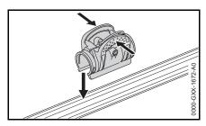
• Ouvrir la pince en pressant les languettes et la fixer sur le tube.
