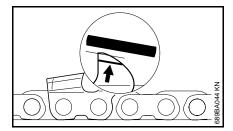
après cela, rectifier le haut du limiteur de profondeur en biais, parallèlement au repère de maintenance (voir la flèche) – en veillant à ne pas raccourcir davantage le sommet du limiteur de profondeur;
