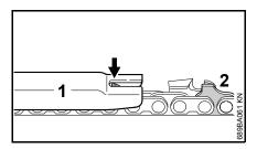
poser sur la chaîne le calibre d'affûtage (1) qui convient pour le pas de la chaîne et le presser sur la dent de coupe à contrôler – si le limiteur de profondeur dépasse du calibre d'affûtage, il faut rectifier le limiteur de profondeur;
