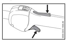
■ Enfoncer le blocage de gâchette d'accélérateur et accélérer – le levier du volet de starter revient dans la position de marche normale I – après un démarrage à froid, faire chauffer le moteur en donnant quelques coups d'accélérateur.
