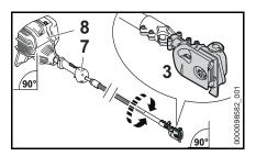
Positionner le carter (8) (avec la pompe d'amorçage manuelle vers le haut), la poignée de commande (7) (avec le bouton d'arrêt vers le haut) et le réducteur (3) (avec le bouchon du réservoir à huile vers le haut) comme montré sur l'illustration.
