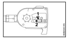
tourner la vis (1) vers la gauche jusqu'à ce que le coulisseau de tension (2) bute contre le bord de la découpure du carter, à gauche, puis revenir de 5 tours en arrière.
